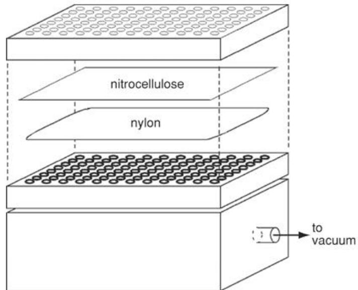
**Figure 2.6 Double-filter dot-blot apparatus**
