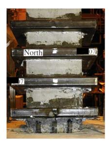
(d) after test (ruptured bars visible)
