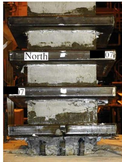
(d) after test (ruptured bars visible)
