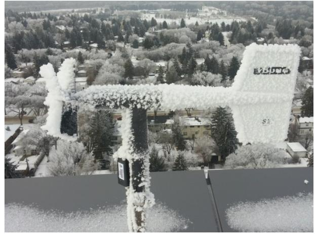
(d) Ultrasonic anemometer and Wind Monitor under icing conditions
