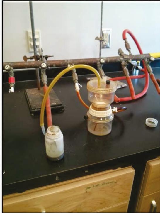
**Photo 19. Light fraction aspiration apparatus**
