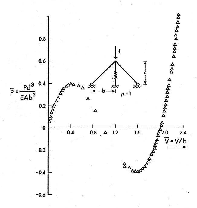
FIG. 10a - AUGMENTED STIFFNESS SOLUTION FOR TWO BAR TRUSS ( $\mu$ =1)
