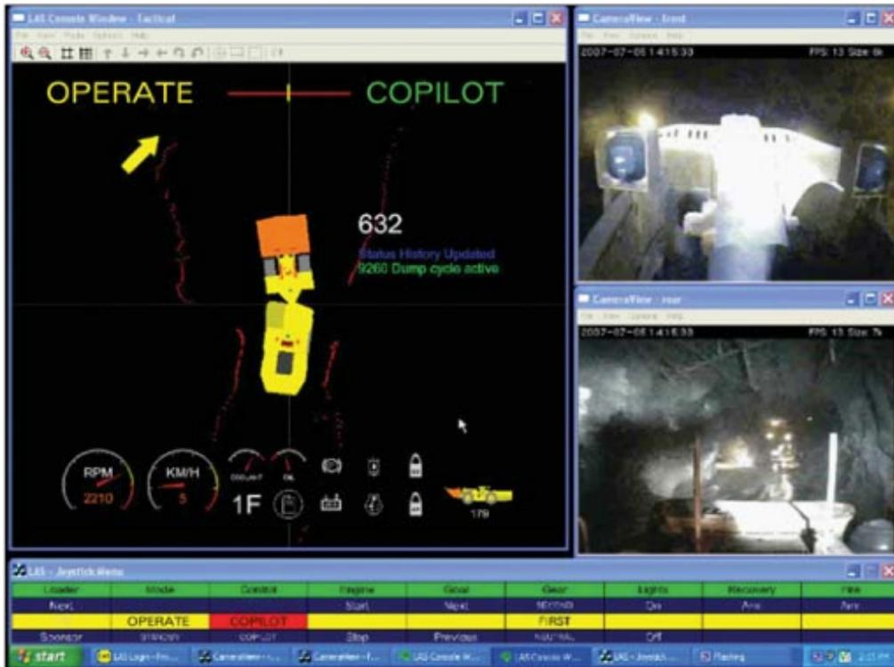
Abbildung 5-1 MineGem Bedienerinterface (Caterpillar 2013 S. 4)
