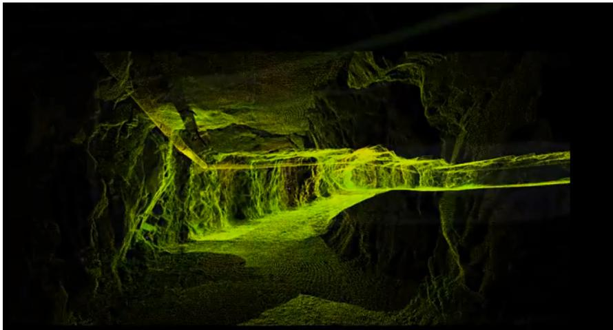
Abbildung 4-6 Visualisierter Laserscan einer Strecke (Darling Geomatics 2015)
