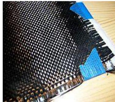
b) Carbon Fibre Polymers
