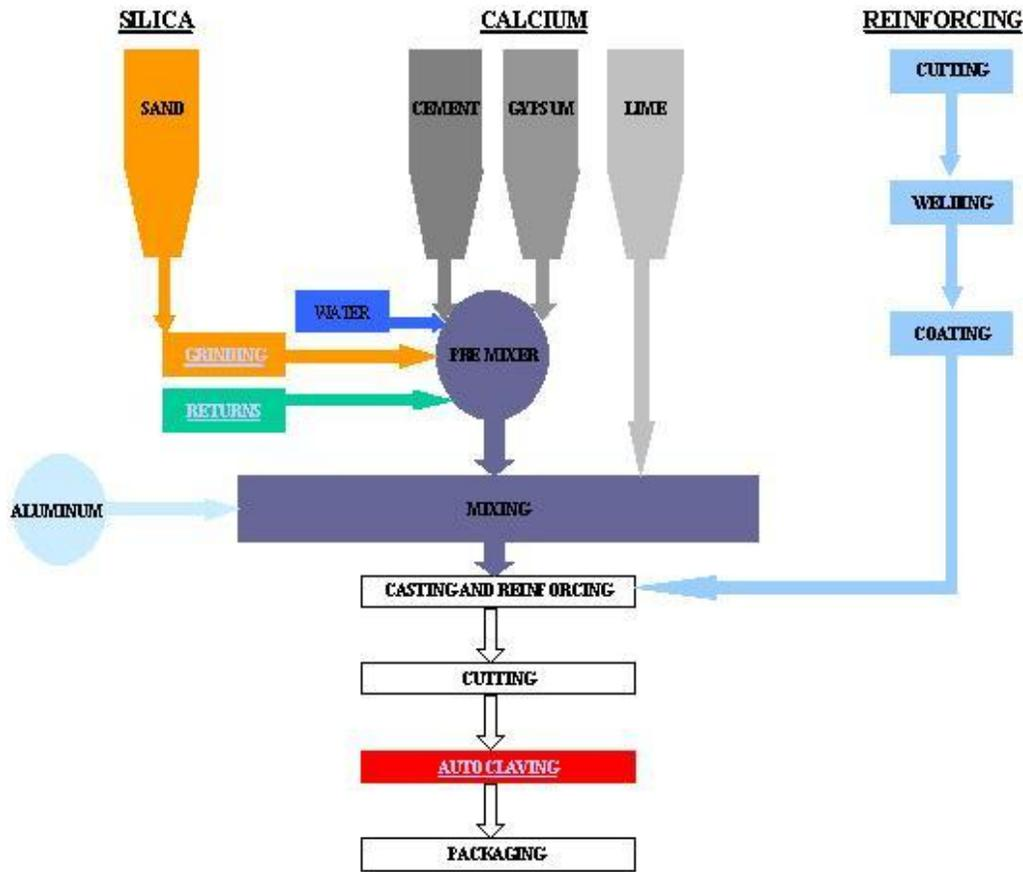
Fig. 2.1: Process Flow Diagram<sup>(2.7)</sup>
