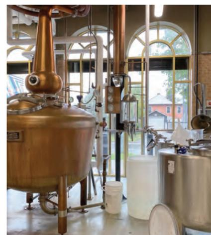
↑ Le wash bout dans l'alambic en cuivre et passe ensuite dans un condenseur afin d'être distillé. Crédit : Chloé Liberge
