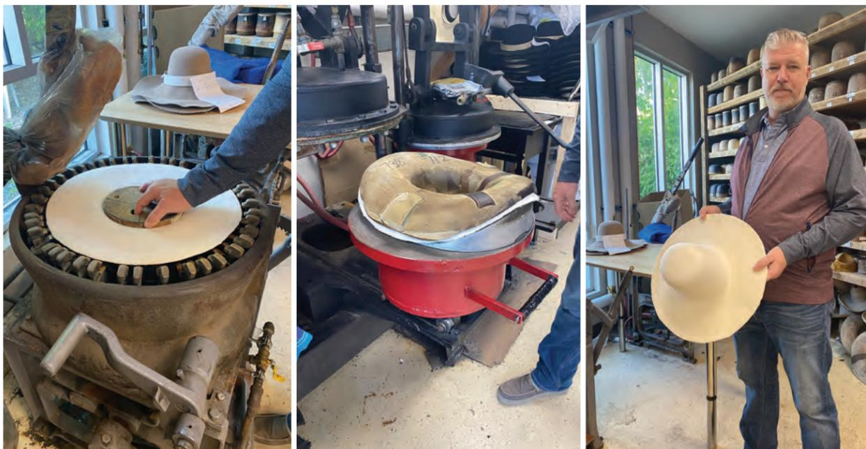
↑ Le bloc de bois solide, placé au milieu de la machine de blocage, permettra de mouler la forme du chapeau. La calotte du chapeau est à nouveau bloquée dans une presse hydraulique afin d'en façonner les bords. Et voilà! La forme de la couronne et des bords est bien modelée; il ne reste plus qu'à effectuer les derniers ajustements. Crédits : Chloé Liberge
