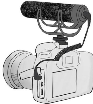
Avant de choisir un microphone, assurez-vous de connaître ses formats d'enregistrement (MP3, WAV, etc.), ses directions d'enregistrement (unidirectionnel, omnidirectionnel ou bidirectionnel; voir l'image ci-dessous), l'espace de stockage qu'il occupera sur votre appareil d'enregistrement et s'il est compatible avec votre équipement d'enregistrement ou s'il vous faudra, par exemple, un adaptateur USB, iPhone ou Android pour relier les deux.
