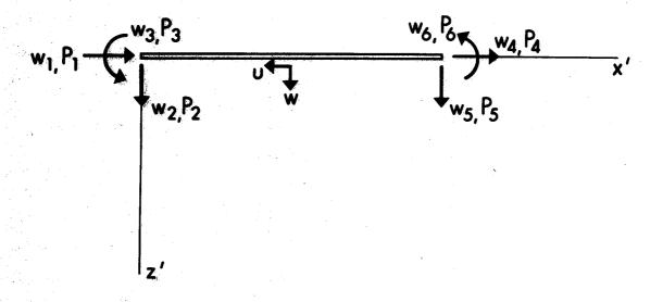
FIGURE 2.6 ELEMENT IN LOCAL COORDINATE SYSTEM
