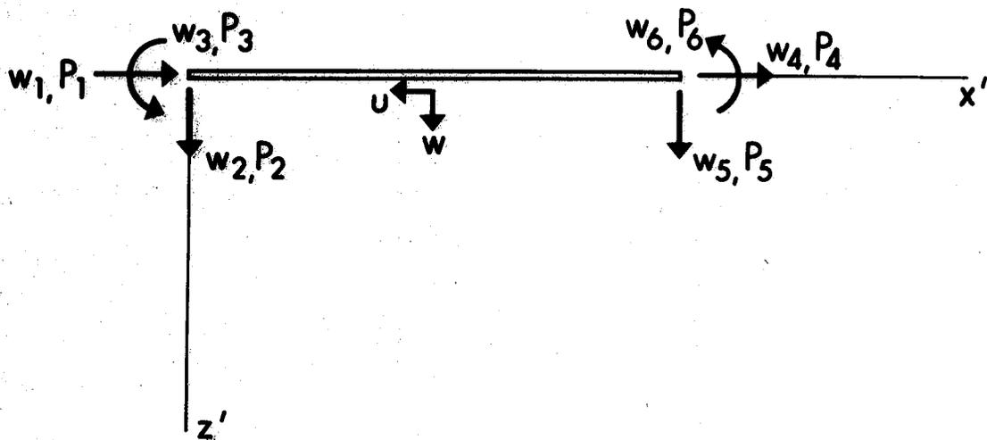
FIGURE 2.6 ELEMENT IN LOCAL COORDINATE SYSTEM
