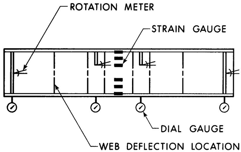
FIG. 3.2 INSTRUMENTATION
