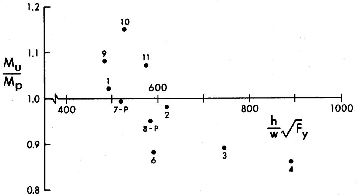
FIG. 4.1 EFFECT OF WEB SLENDERNESS ON MOMENT CAPACITY
