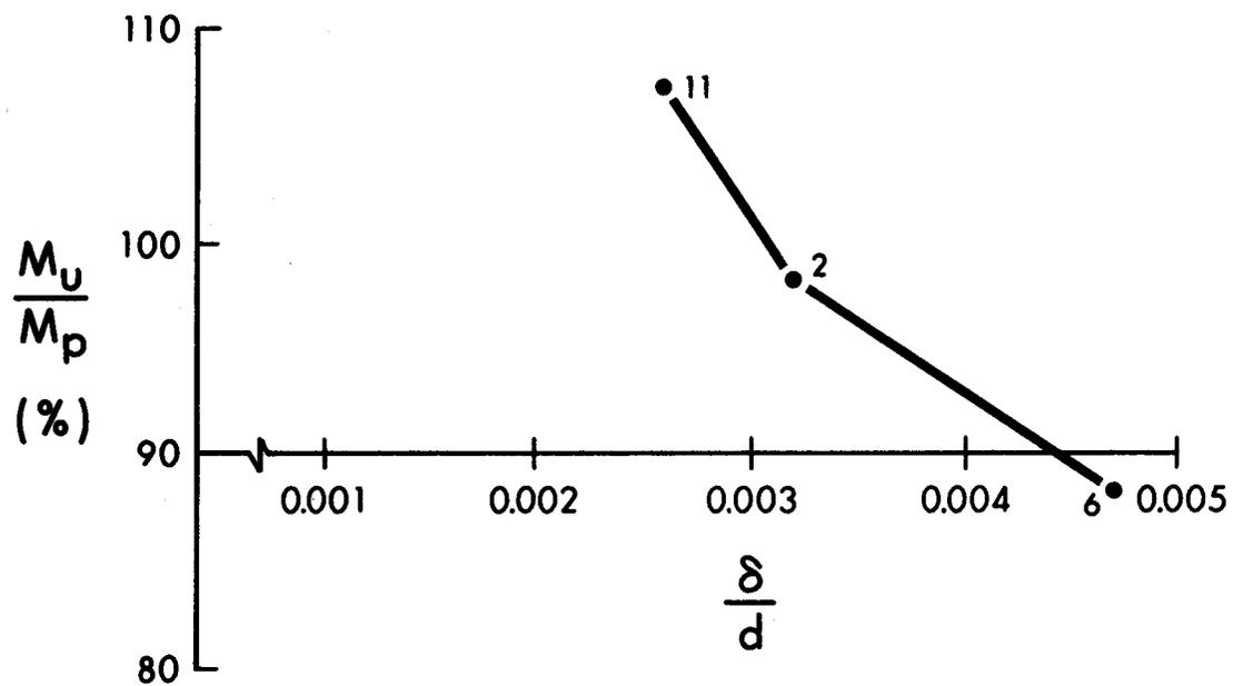
FIG. 5.1 EFFECT OF INITIAL WEB DEFLECTION ON MOMENT CAPACITY
