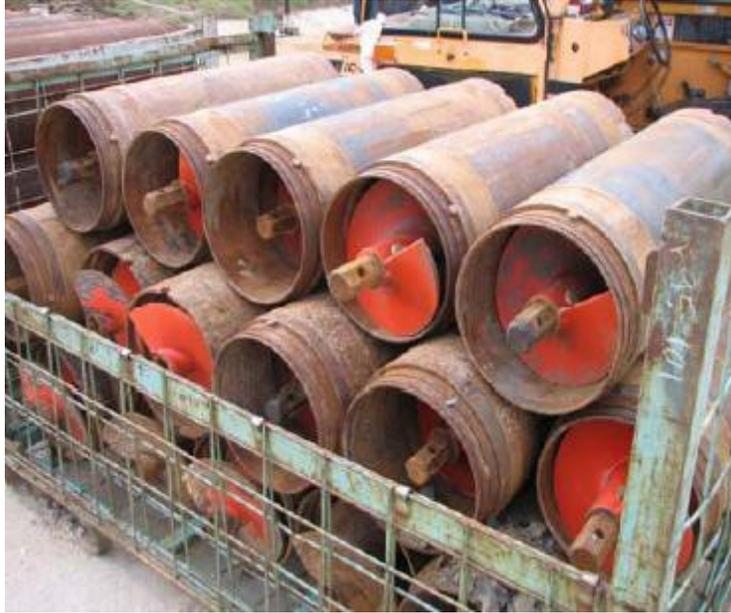
**Figure 2.6 Auger casings (Boschert 2007)**
