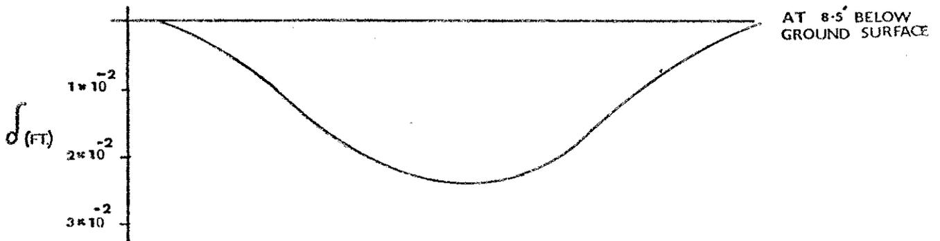
NOTE UNSYMMETRICAL DUE TO ELEMENT ORIENTATION AT 8.5' LEVEL
