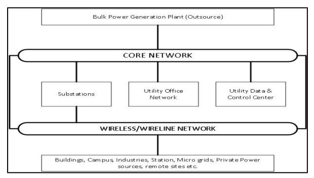
Figure 3 – Core Edge Arcitecture
