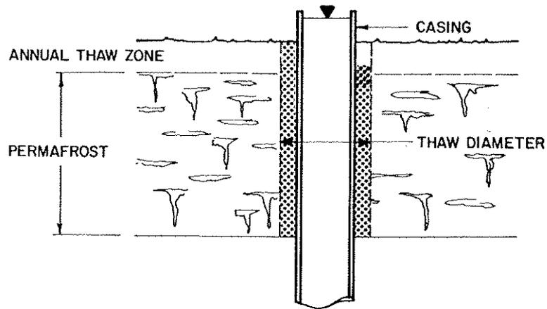
FIGURE 5.1 THAW AROUND WELL CASING .
