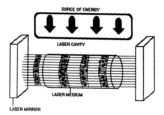
FIGURE 4: BUILD UP OF PHOTON RESONANCE INSIDE THE LASER CAVITY
