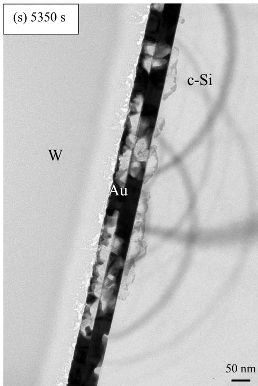
Figure 7.3. BF cross section TEM images of Au/a-Si/c-Si sample annealed at 250°C for (a) 850 s, (b) 1100 s, (c) 1350 s, (d) 1600 s, (e) 1850 s, (f) 2100 s, (g) 2350 s, (h) 2600 s, (i) 2850 s, (j) 3100 s, (k) 3350 s, (l) 3600 s, (m) 3850 s, (n) 4100 s, (o) 4350 s, (p) 4600 s, (q) 4850 s, (r) 5100 s and (s) 5350 s.
