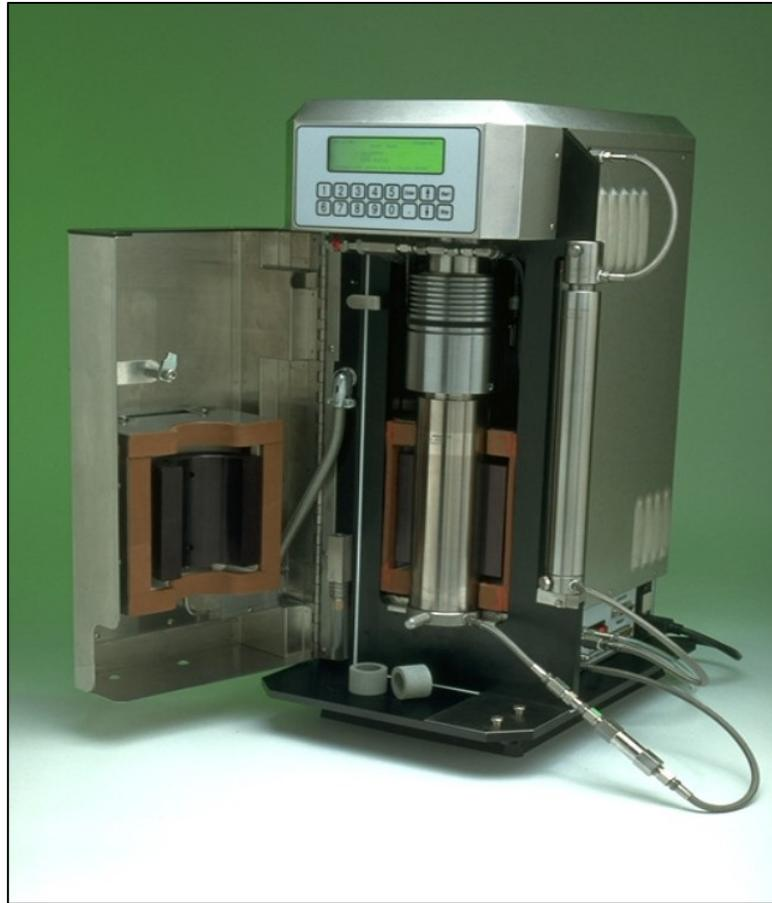
**Figure 3.6. FANN 90 Dynamic Filtration apparatus**
