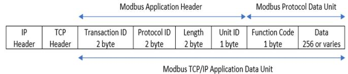
Fig. 4. Modbus TCP/IP message structure
