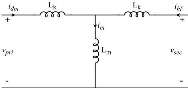
Fig. 3. 29. Transformer T model.
