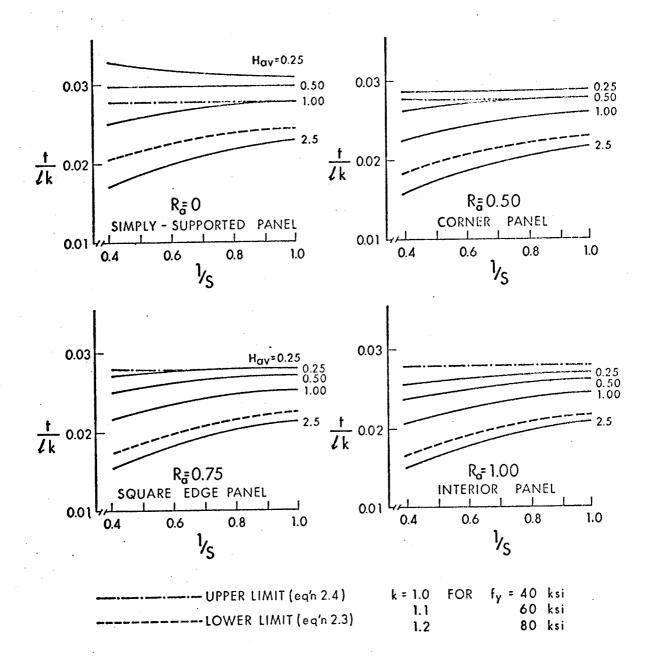
FIGURE 2.1 MINIMUM SLAB THICKNESSES
