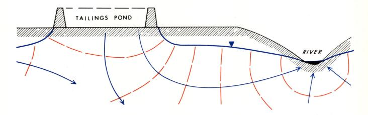
b) POSSIBLE EFFECT OF TAILINGS POND ON GROUNDWATER FLOW SYSTEM
