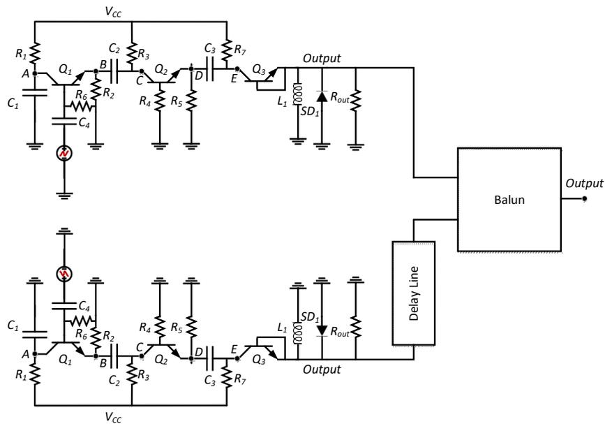
Fig. 30. Monopulse generator schematic
