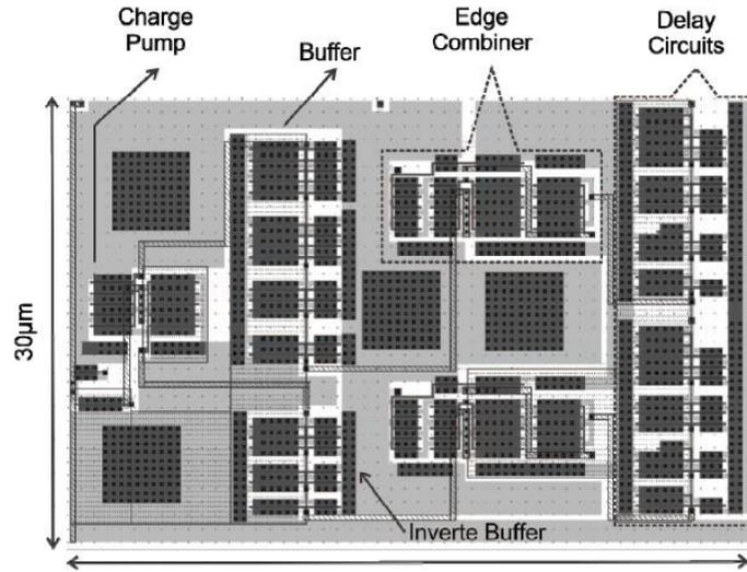
Fig. 23. Fabricated IC [34]
