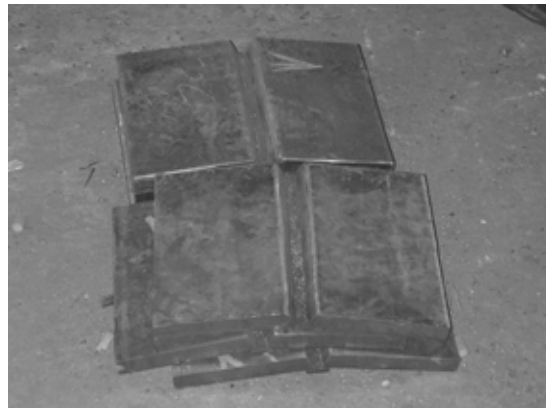
(d) All-weld test specimens before welding
