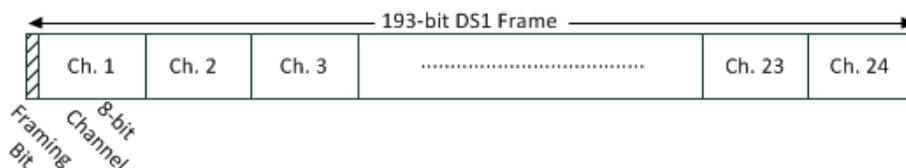
Figure C.2: Illustration of a 193-bit DS1 frame.
