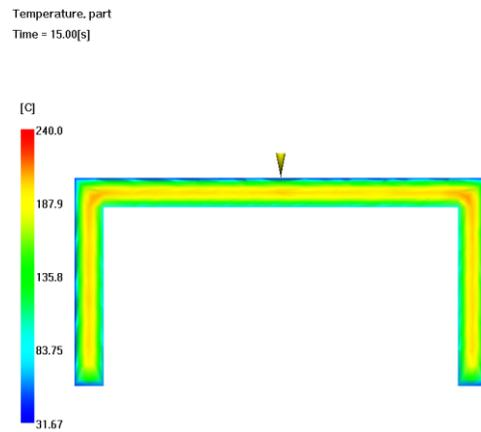
(d) Temperature distribution simulation result for case c
