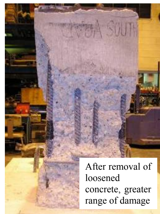
(d) At end of test (South side)
