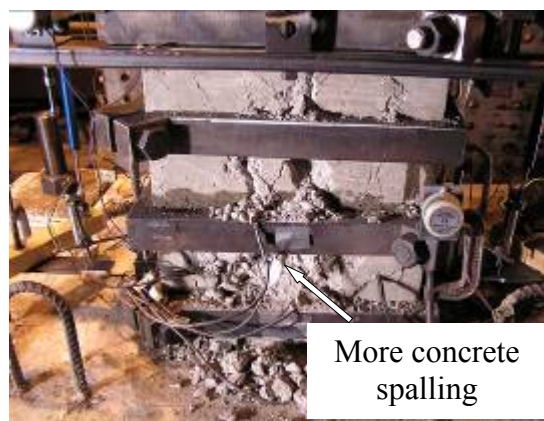
(d) At cycle 25 ( \mu=6 ) (West side)
