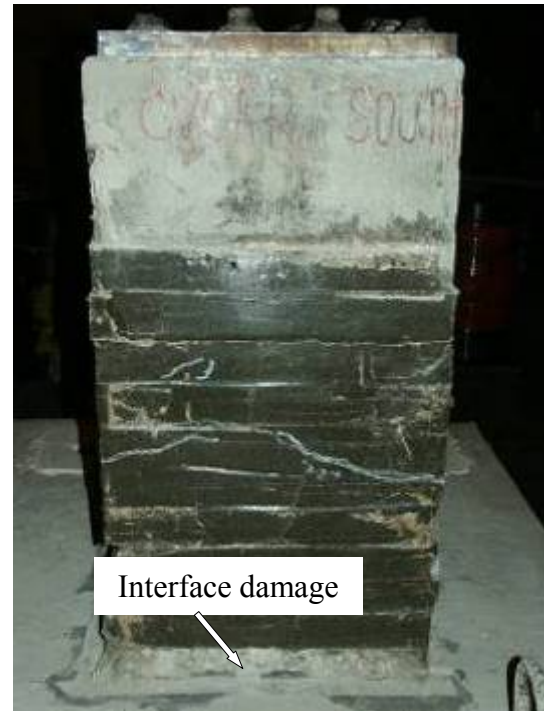
(d) At end of test (South side)
