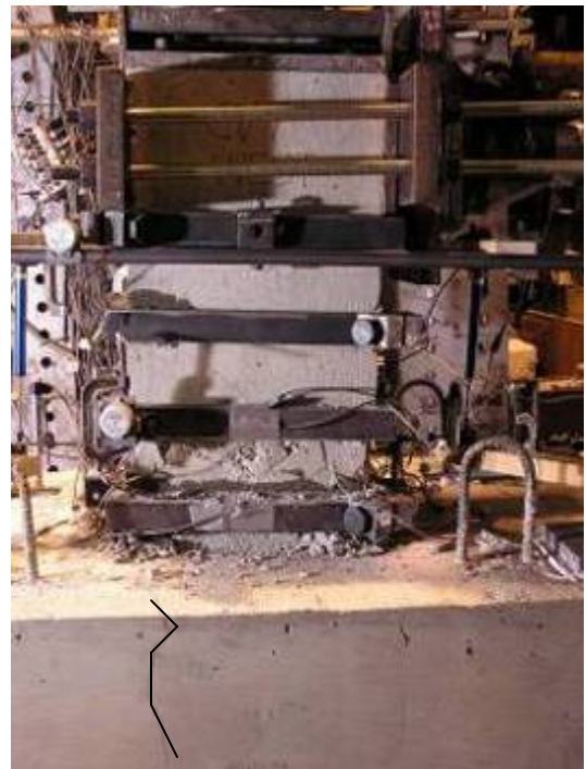
(d) At cycle 29 ( \mu=8 ) (West side)
